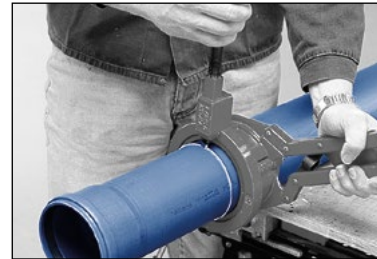
Katkaiseminen katkaisu- ja viisteytyslaitteella (KUVA 16)
