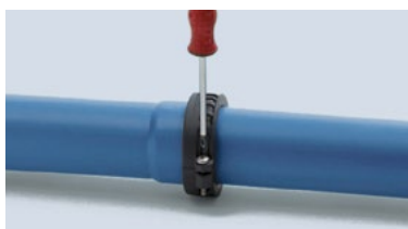
Lopuksi ruuvi kiristetään. Kiristysmomentti on 5–7 Nm. Muotokappaleliitoksia DN/OD 32–90 mm vedetään 5 mm erilleen toisistaan ennen POLO-KAL NG ASV:n asentamista. (KUVA 3)
